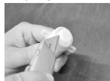
4. wyciągnięcie zabezpieczenia turbinki
